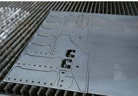
Der neue Plasmaschneider positioniert die auszuscheidenden Teile effizienter.
