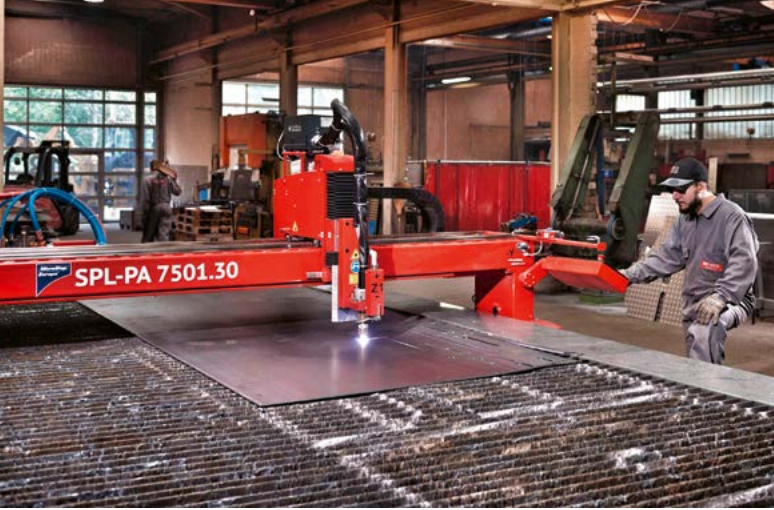
Die neue Plasma-Schneidanlage arbeitet sauberer, schneller und macht weniger Abfall.
