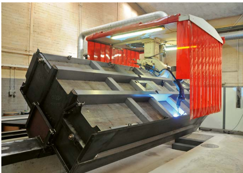
Mit der drehbaren Lehre kann das gesamte Kipperprogramm für 3-, 4- und 5-Achser automatisch geschweisst werden.
